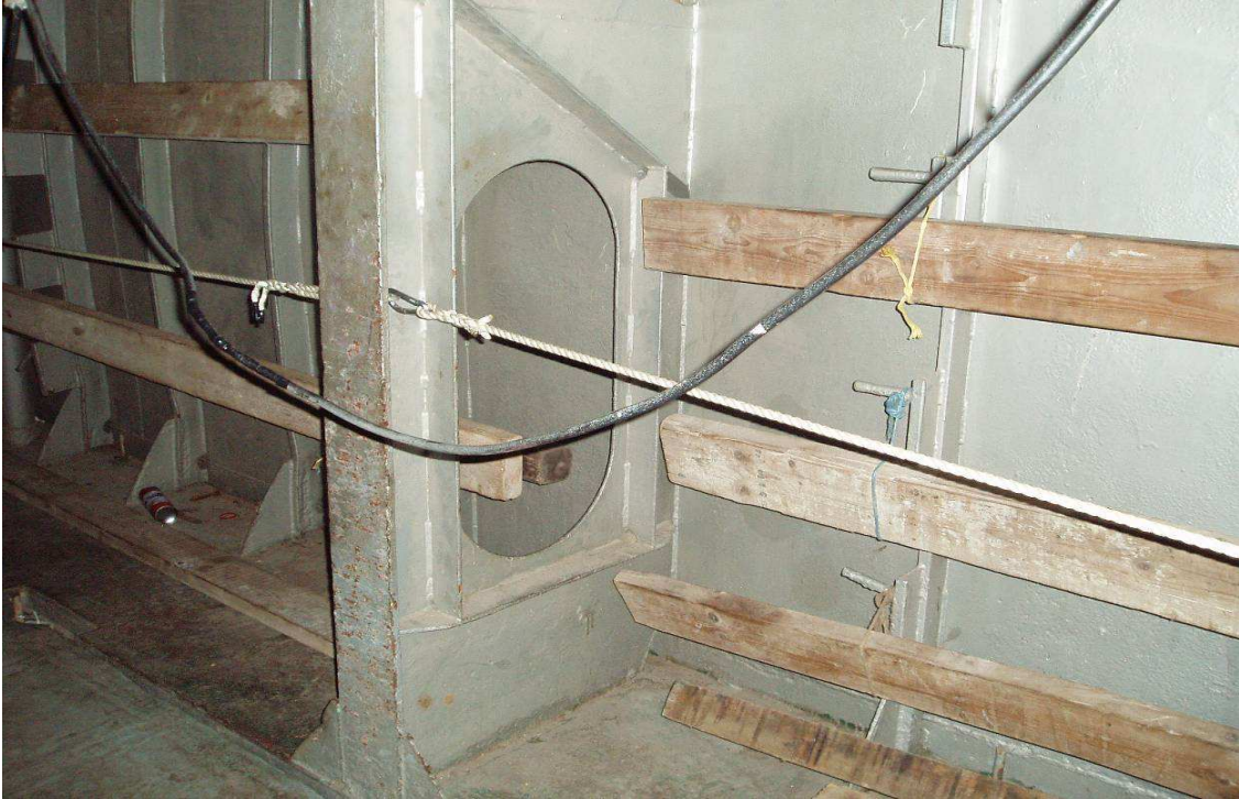
Passagen og webframe efter montering af stræktov med karabinhage
